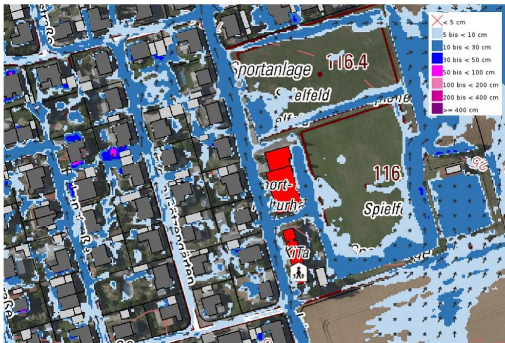
Abb. 36: Überflutungsgefährdung am südlichen Ortsrand, Sturzflutgefahrenkarte für extremen Starkregen, SRI 10, 4 Std. [1]
