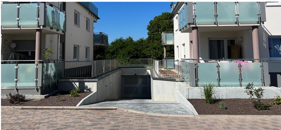
*Abb. 85: Beispiele für überflutungsfördernde Bauweise durch abschüssige Garagenzufahrten, Bild unten: Tiefgarage*
