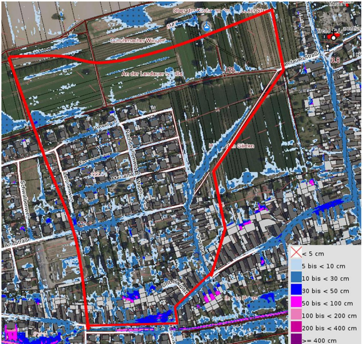
Abb. 95: Einzugsgebiet (rot) zur Unteren Hauptstraße und zum Hofgraben, Sturzflutgefahrenkarte für SRI 1 Std. [1]
