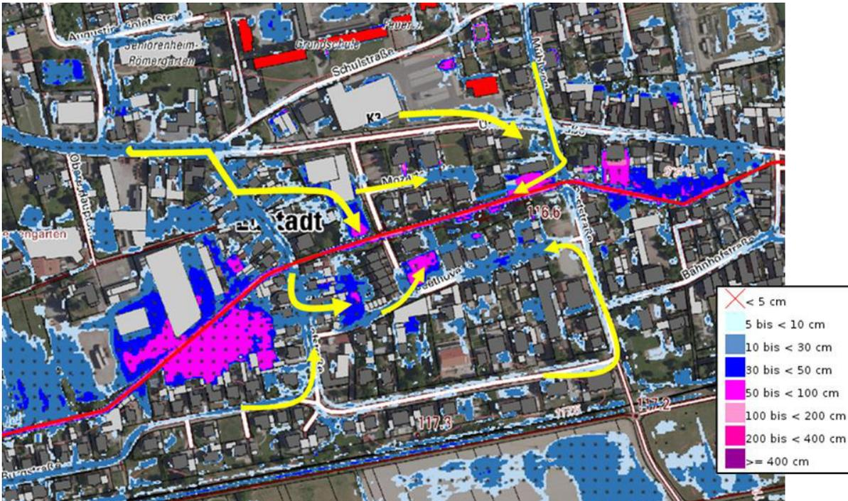
Abb. 76: Fließrichtungen (gelbe Pfeile) südlich und nördlich des Hofgrabens bei außergewöhnlichen Starkregen, Sturzflutgefahrenkarte für SRI 7, 1 Std. [1]
