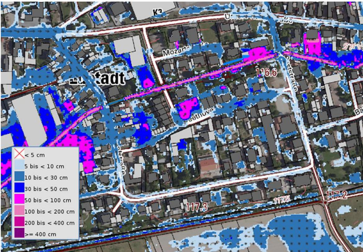
Abb. 72: Überflutungsgefährdung der Ortslage zwischen Bahnhofstraße, Unterer Hauptstraße, Poststraße und Museumsbahn, Sturzflutgefahrenkarte für SRI 7, 1 Std. [1]
