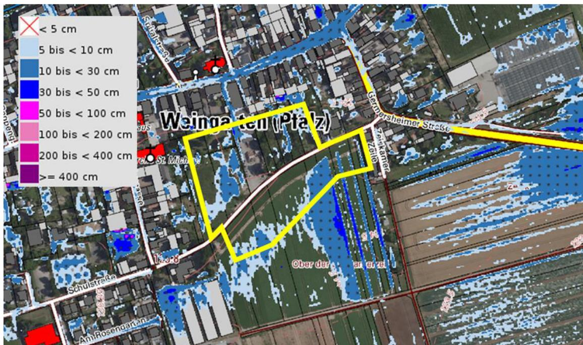
Abb. 17: Standort für ein Neubaugebiet an der Schulstraße, Sturzflutgefahrenkarte für SRI 7, 1 Std. [1]
