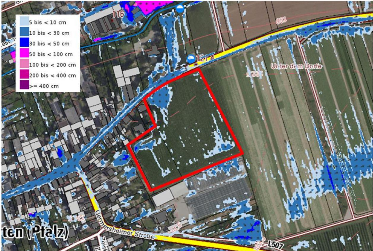
Abb. 30: Überflutungsgefährdung an der Hauptstraße im Osten der Ortslage, Sturzflutgefahrenkarten für SRI 7, 1 Std. [1]
