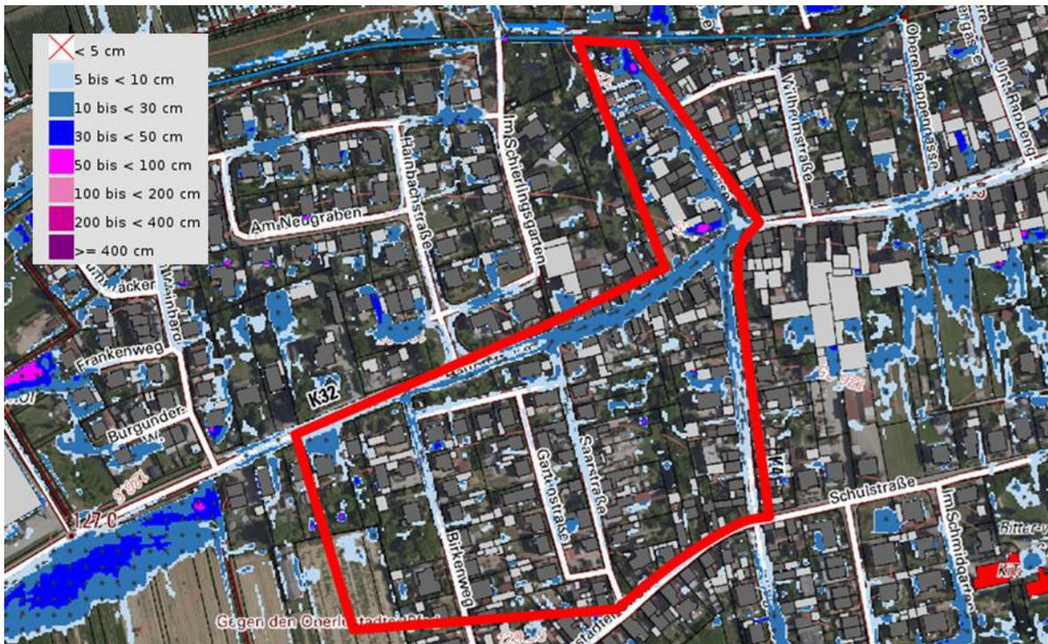
Abb. 58: Entwässerungsgebiet (rot) der Kerngasse, Sturzflutgefahrenkarte für SRI 7, 1 Std. [1]
