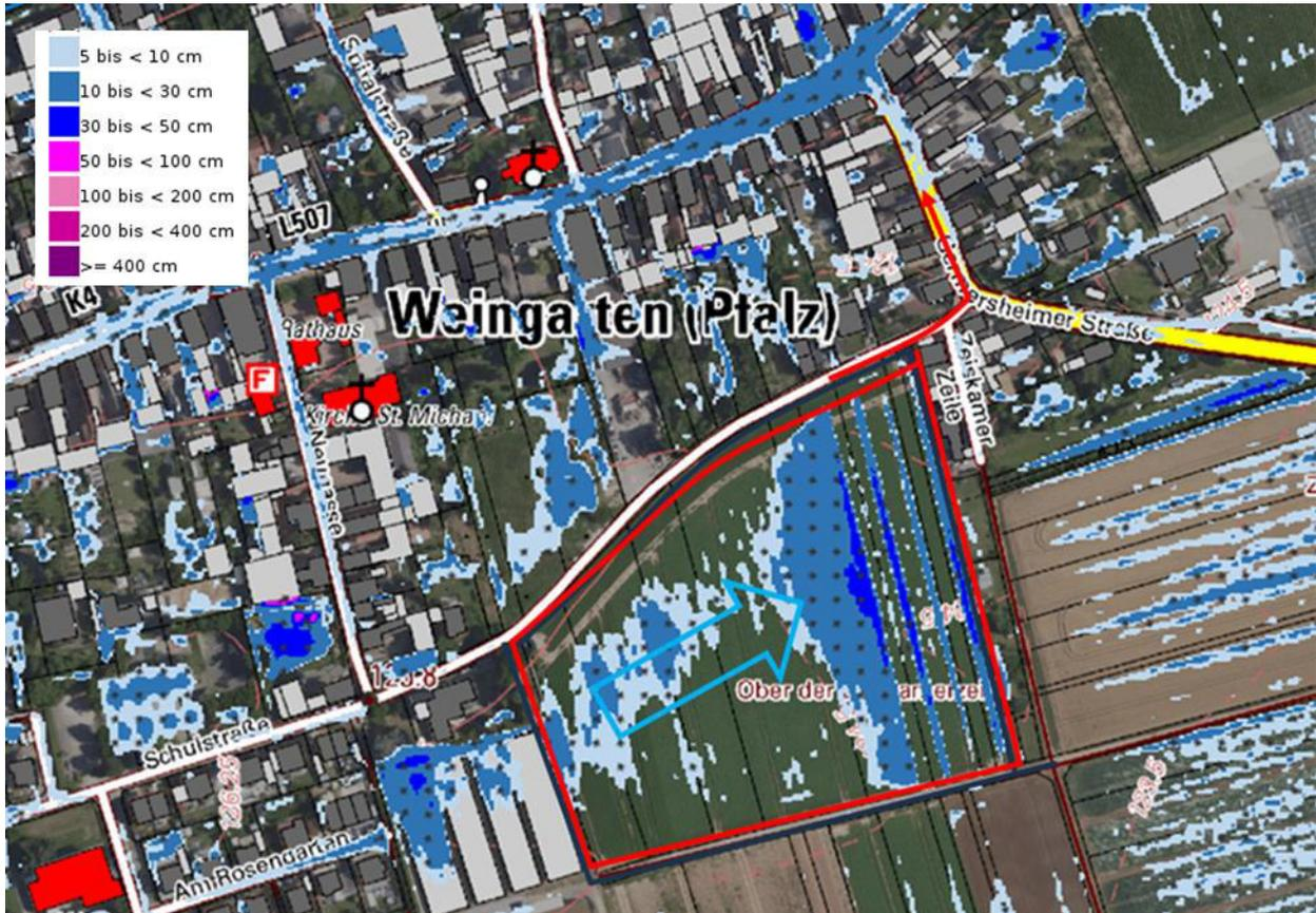
Abb. 26: Außengebiet (rot) in der Gewanne „Ober der Zeiskamerzeil“, Sturzflutgefahrenkarte für SRI 7, 1 Std. [1]
