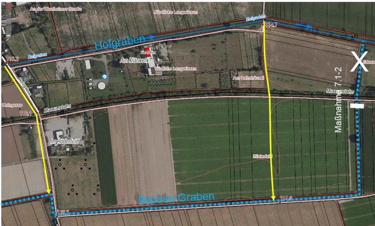
Abb. 28: Potenzielle Standorte für Entlastungsgräben (gelb) vom Hofgraben in den Bypass-Graben
